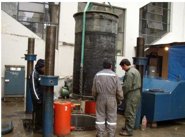
Figura 1: Montaje de la Probeta en la Cámara Triaxial
