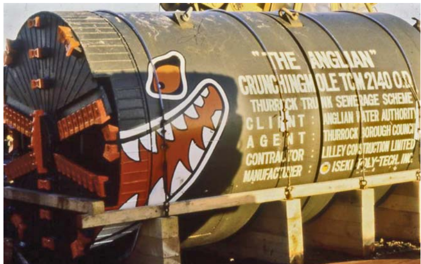
Foto 13. Topo "triturador" de diámetro similar al empleado en Sistema Colector de Aguas en Valparaíso.
