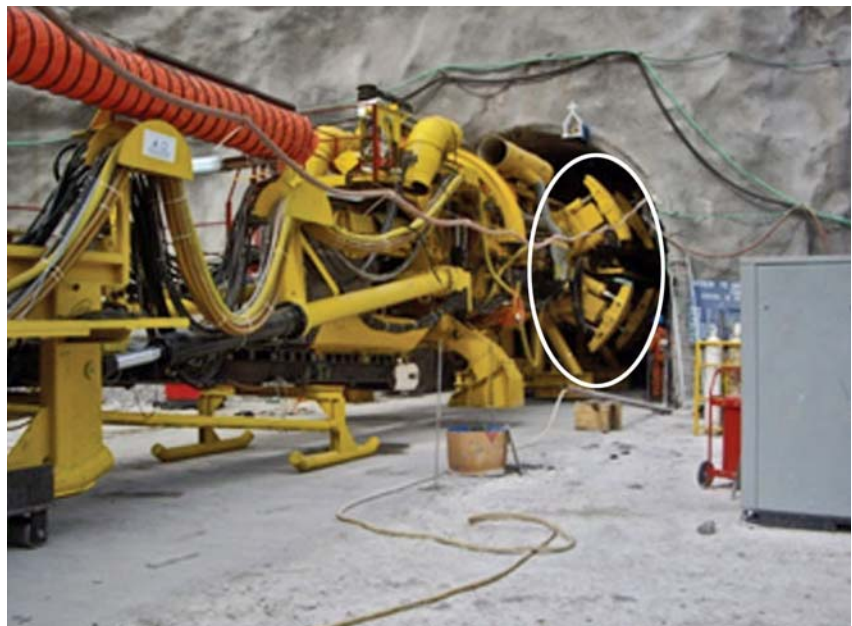
Foto14. Open TBM ingresando al sector de Arranque del Túnel Cipreses, nótese los grippers en forma de “x” de Wirth (círculo de color blanco). Para mayor información ver www.tunneltalk.com .
