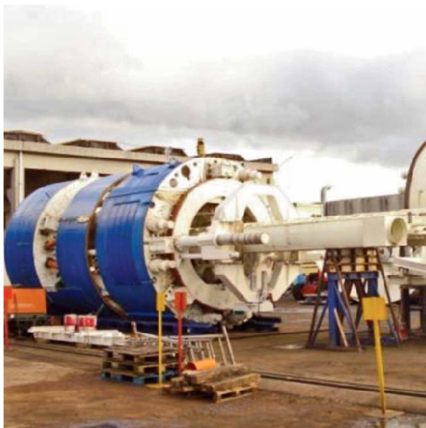
Foto 8: Montaje de la TBM en las instalaciones SELI en Aprilia, Italia.
